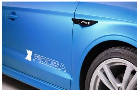
El retrovisor electrónico destaca por ampliar el campo de visión, eliminando los ángulos muertos. A su vez, el reducido tamaño de las cámaras mejora notablemente el coeficiente aerodinámico del automóvil lo que repercute en una reducción del consumo de combustible y del ruido del viento que se percibe desde dentro del vehículo.
