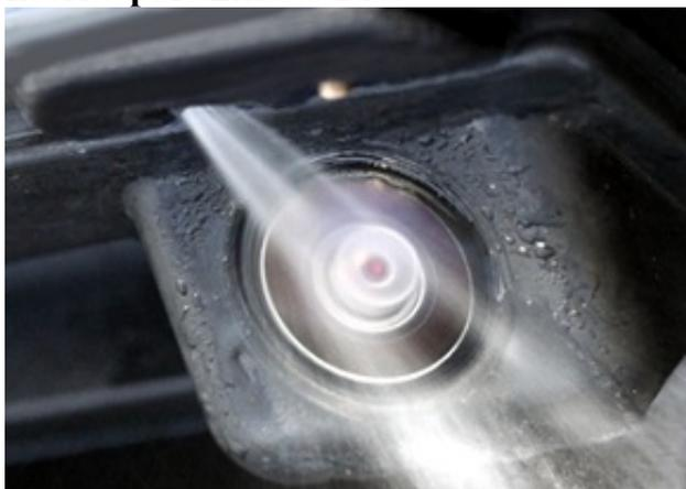
**A Ficosa afirma estar revolucionando o mercado de sensores e câmeras instaladas em automóveis com uma pioneira solução para limpar as lentes desses dispositivos automaticamente. Batizada de Sensor & Camera Cleaning pela companhia, o inovador produto remove a sujeira das câmeras e sensores através de um sistema híbrido que expelle água e/ou ar comprimido dependendo da necessidade e da posição da lente, garantindo o desempenho do dispositivo em tempo integral**
