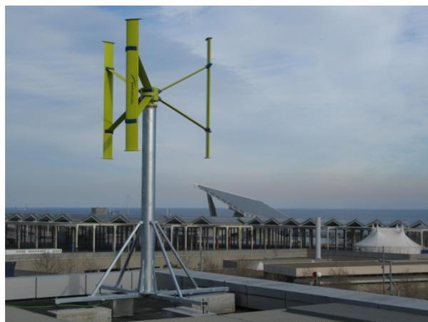
La inercia de rotación de las aspas le convierte en un dispositivo extremadamente eficaz en zonas en las que otros tipos de aerogeneradores deben redirigirse y reiniciarse.
