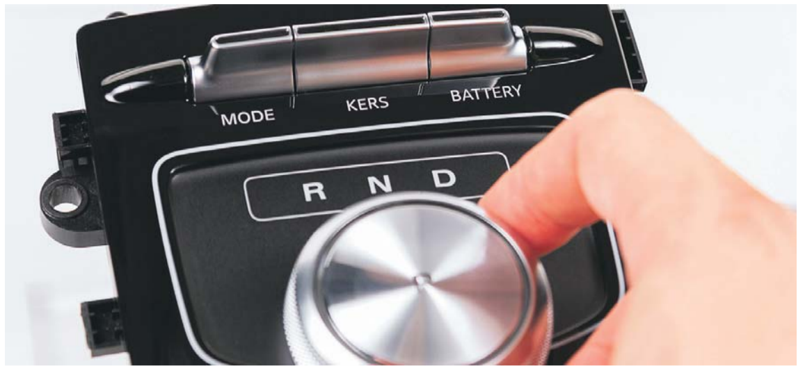
El sistema "by wire" es un cambio de última generación que funciona a través de controles electrónicos.
